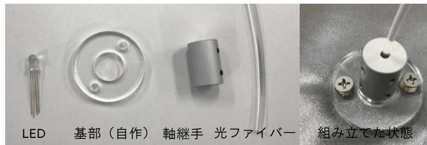
LED 基部（自作） 軸継手 光ファイバー 組み立てた状態
