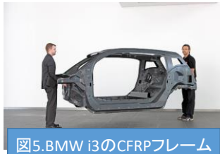
図5. BMW i3のCFRPフレーム
